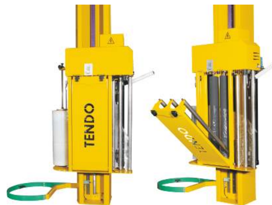
Wózek z folią wyposażony w system Power Pre-Stretch
